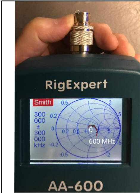
Metallschichtwiderstand 51 \Omega sehr kurz angeschlossen
