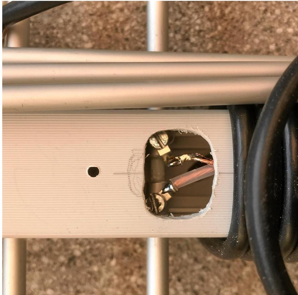
Die Mantelwellensperre für den 2 m - Strahler ist auf ein 2,5 cm PVC-Rohr gewickelt und ist in die Anschlußdose gelegt. .
