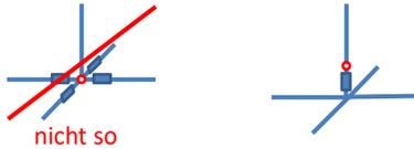
Aufbau eines Radialsystems in 4m Höhe mit **4 m langen** ( $\lambda/20$ ) **Radials** ergibt schon gute Ergebnisse (Verluste durch die Radial-Verlängerungsspule maximal 1%)
