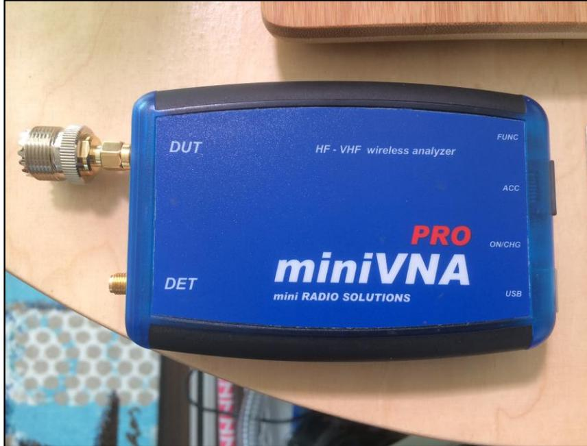
Dieser **Antennen-Analyzer** wurde über Bluetooth mit einem Tablet gekoppelt. Dadurch konnte eine Verfälschung der Messungen durch ein längeres Speisekabel vermieden werden. Die erste Messung ergab für die „J-Antenne“ eine **Resonanz bei 7.600 KHz**. Nach einer Längenkorrektur lag die Resonanz ziemlich genau bei 7.100 kHz.
