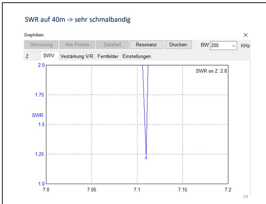
Wegen der schmalen Geometrie wäre diese Antenne auch sehr **schmalbandig**. Und es wäre eine **Monobandantenne**.
