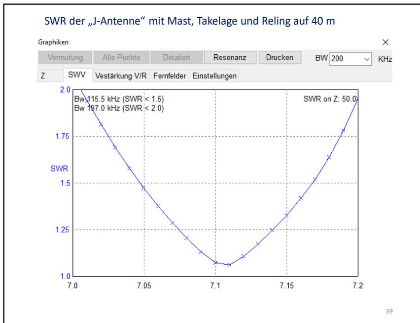
Jetzt beträgt die **Bandbreite 197 kHz**. Ohne Mast, Takelage und Reling beträgt sie **nur 174 kHz**. Offensichtlich werden dadurch zusätzliche Verluste eingebracht.
