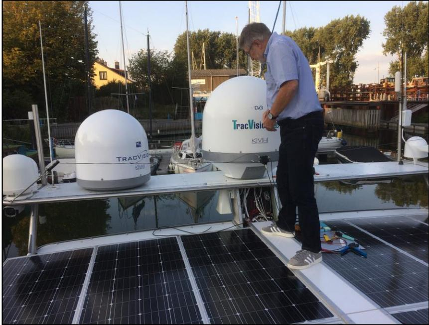
Die Traverse trägt auch die verschiedenen Satellitenantennen. Darunter sind die **Solarpanels** zu sehen. Sie versorgen das Schiff mit **95% der benötigten elektrischen Energie**. Hinten in dem geöffneten **Kabelschacht** befindet sich der **ATU SG230**.
