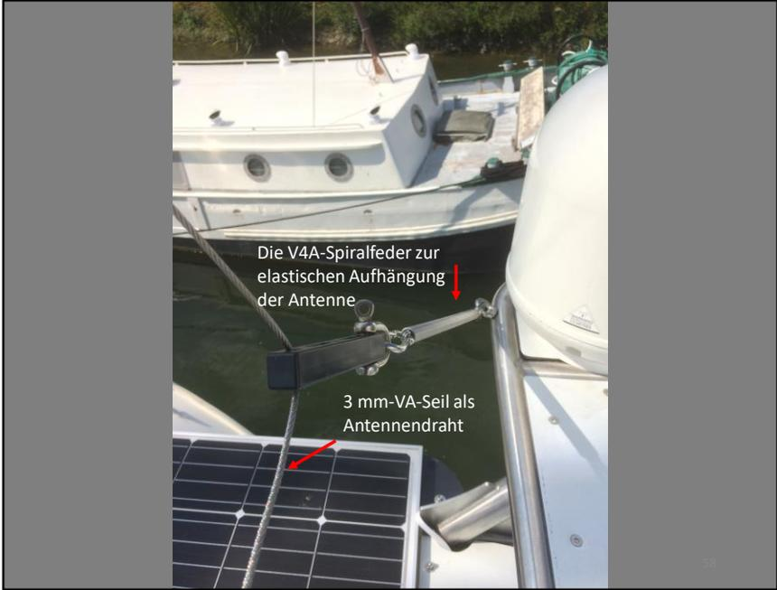
Die V4-Spiralfeder zur elastischen Aufhängung der Antenne
